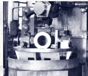
Großes hydraulisch betätigtes automatisches Schwenkfutter zur Bearbeitung eines Ventilgehäuses von vier Seiten auf einer Senkrechtdrehmaschine.
